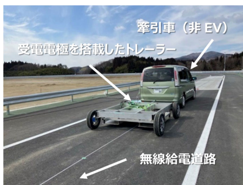
写真-3 走行中給電実験状況
