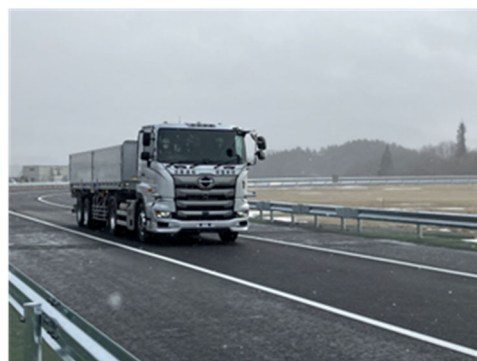
写真-4 促進載荷試験状況
