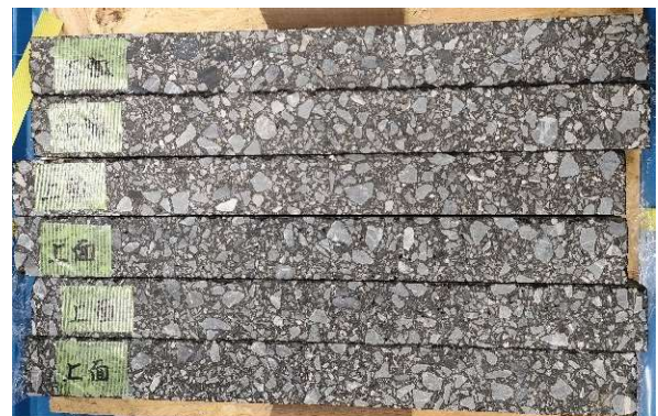
図-2 作製した6本の供試体
